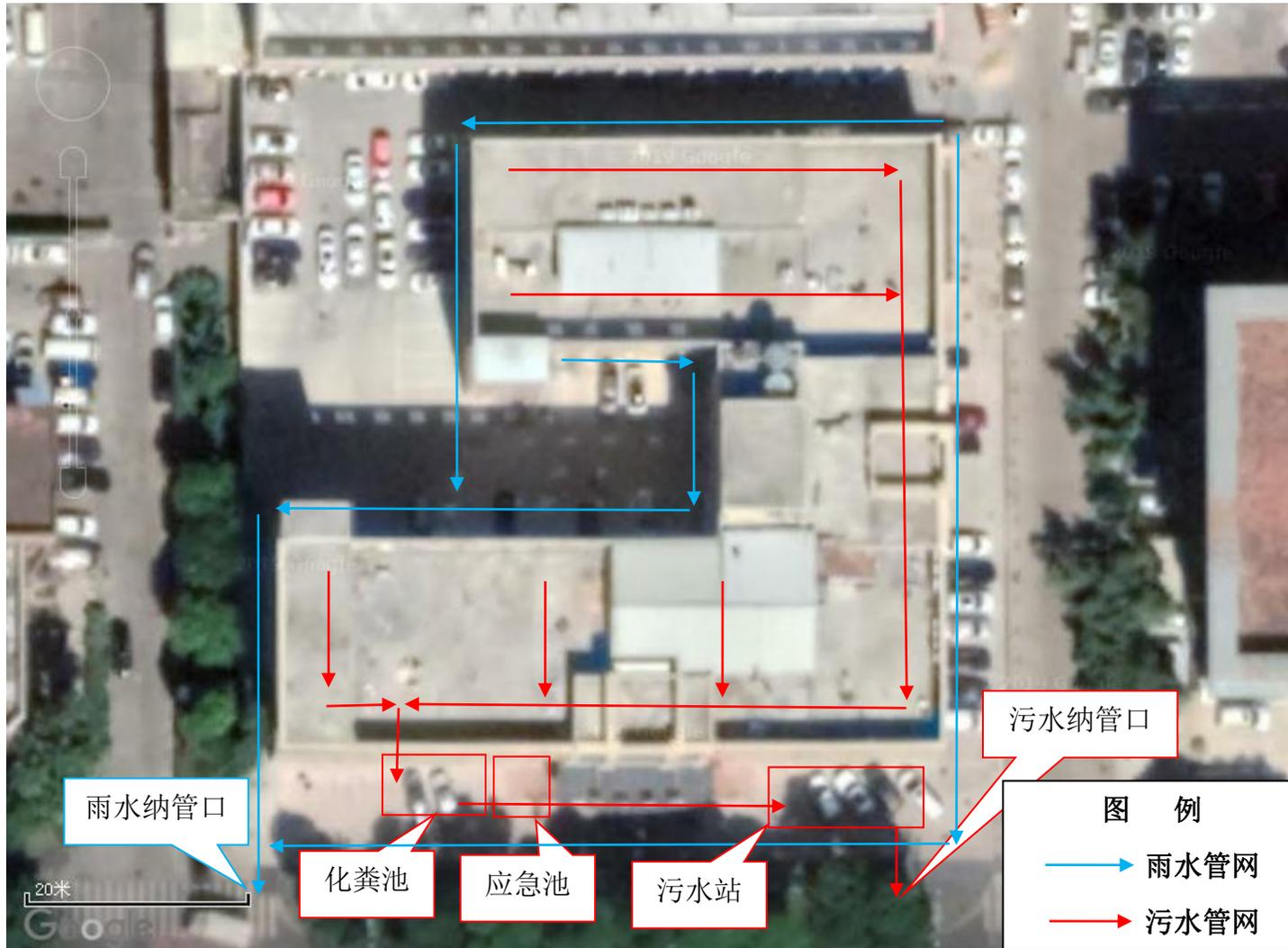
图 10.5.1 厂区雨、污水管网分布图
